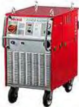
>> Apto para antorchas de corte por plasma refrigeradas por agua. Control por transistores: serie ajustable de corriente de corte. **Gas plasma: aire comprimido.** Sistema de ignición: HF. Antorcha de plasma con conexión independiente: conexión directa para antorcha de plasma opcional. Control térmico, ventilador silencioso. Protección de sobrecarga térmica. Conector y sistema de **protección antipolvo.** Indicador S. **Conector para control remoto y apto para descarnar.**
